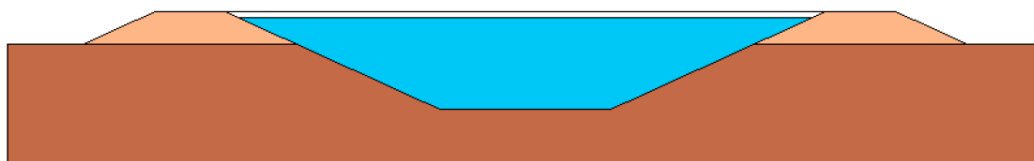
Figur 5.7. Vertikalt tvärsnitt av ett gropmagasin.
